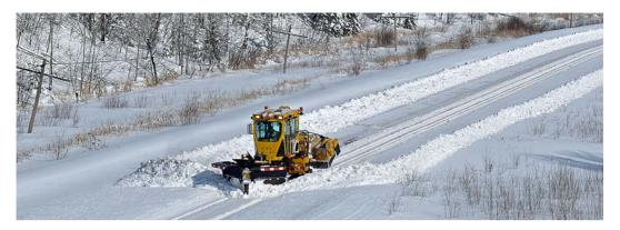
Figure 5-1 : Régaleuse sur une section au sol de l'antenne Deux-Montagnes
