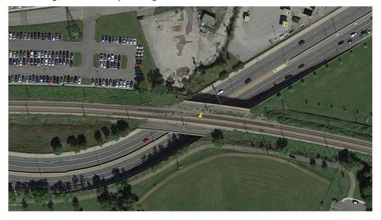
Figure 2-16 : Exemple d'étagement inférieur de la route sous une voie ferrée
